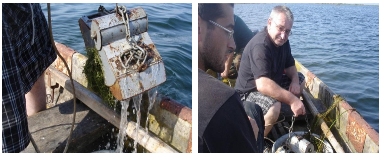
Рисунок 1.8 - Отбор проб зообентоса с применением дночерпателя Петерсена ( 0,025\text{ м}^2 )
