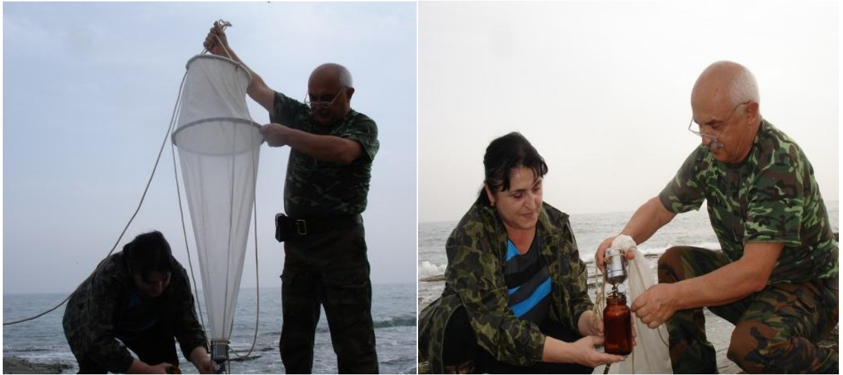
Рисунок 1.5 - Модернизированная для условий побережья Каспия планктонная сеть Апштейна (малая модель) с фирменным планктонным стаканом
