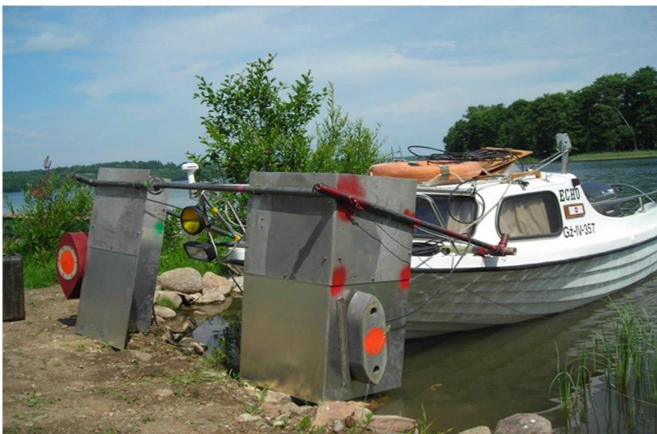
Рисунок 2.2 - Фотография крепления гидроакустических антенн эхолотов EY60 на НИС польского института пресноводного рыболовства (г. Ольштын): левая антенна для вертикальной, правая – для горизонтальной локации
