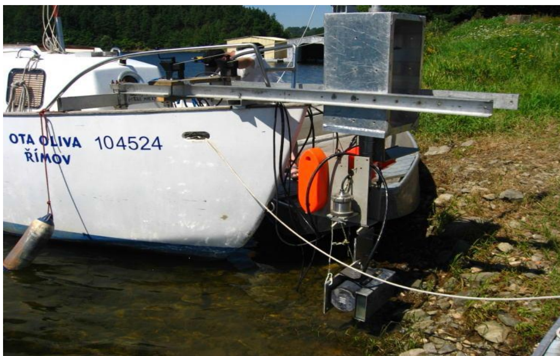
Рисунок 2.4 - Правая фотография: крепление разночастотных гидроакустических антенн эхолотов EY60 для вертикальной локализации и антенны двухчастотного гидроакустического идентификационного сонара Didson (США)
